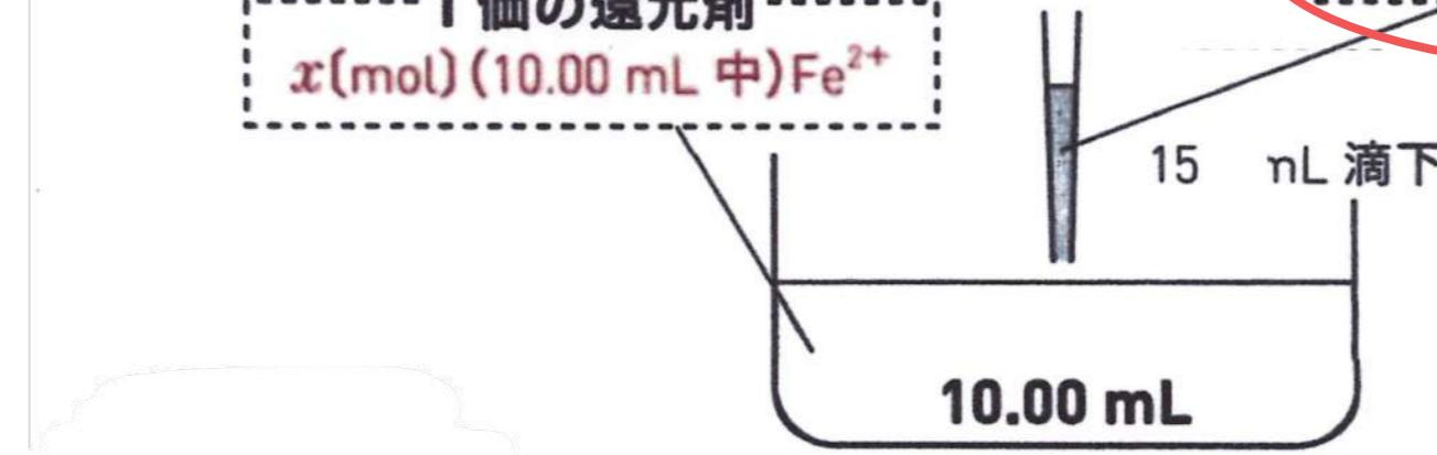
別に溶液Aを10.00 mLはかりとり, 7.0%の過酸化水素水溶液1.0 gを加えて加熱した。次に, この溶液がアルカリ性になるまでアンモニア水を加え, 生じた沈殿をこしわけた。沈殿を強熱し, 完全に酸化物としてから質量をはかったところ, 0.32 gであった。
