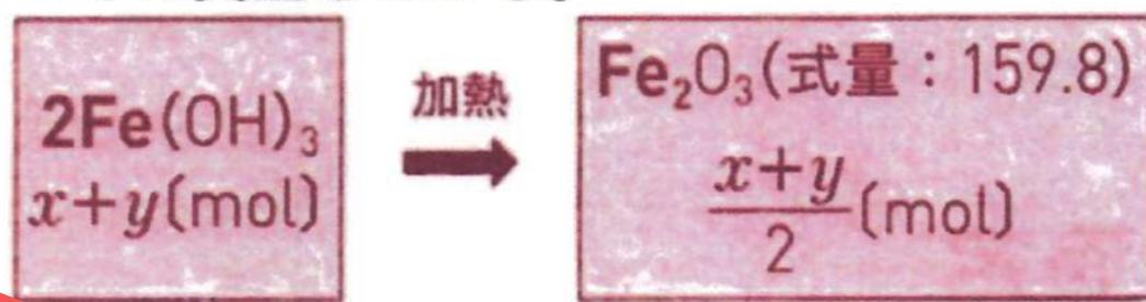
別に溶液Aを10.00 mLはかりとり, 7.0%の過酸化水素水溶液1.0 gを加えて加熱した。次に, この溶液がアルカリ性になるまでアンモニア水を加え, 生じた沈殿をこしわけた。沈殿を強熱し, 完全に酸化物としてから質量をはかったところ, 0.32 gであった。
