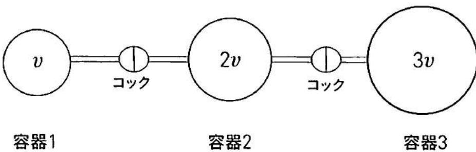
容器 1 には圧力  $4p(Pa)$  の気体 A, 容器 2 には圧力  $p(Pa)$  の気体 B, 容器 3 には圧力  $2p(Pa)$  の気体 C が封入されている。気体の温度はすべて  $T(K)$  である。次の問いの計算に際しては、気体はすべて理想気体とし、気体定数は  $R(Pa \cdot L/(K \cdot mol))$  とする。また、コックと連結管の体積は無視する。
