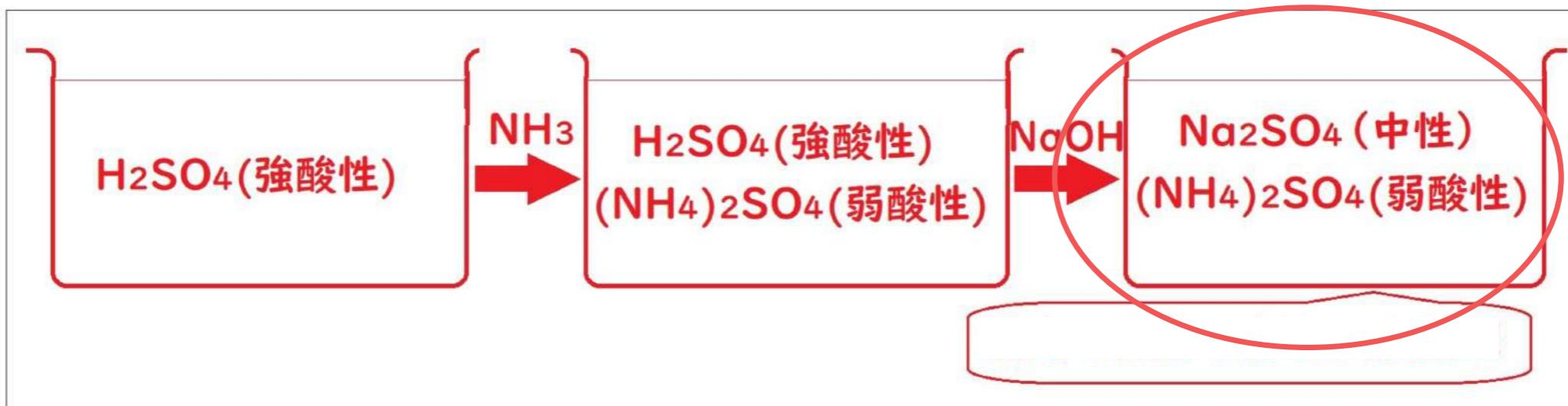
(b) 理由；滴定の終点の液性は弱酸性である。よって、弱酸性付近に変色域が存在する指示薬を用いることが適当である。
