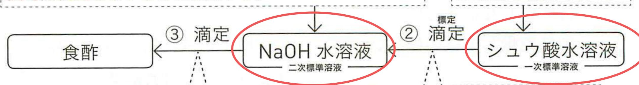
指示薬として、1, 2滴のフェノールフタレン溶液を加えて滴定する。混合溶液が薄い赤色になり、振り混ぜてもその色が消えなくなったところで滴下を終える。
