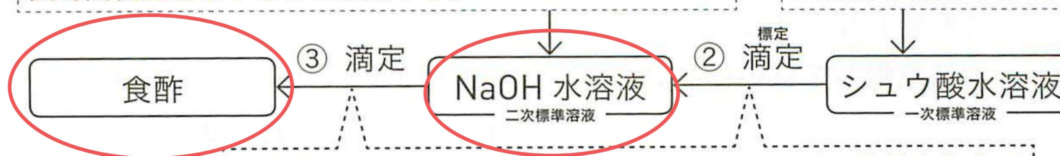
指示薬として、1, 2滴のフェノールフタレン溶液を加えて滴定する。混合溶液が薄い赤色になり、振り混ぜてもその色が消えなくなったところで滴下を終える。
