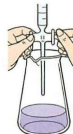
②定量したい還元剤( $H_2S$ )を加え、反応させる。
